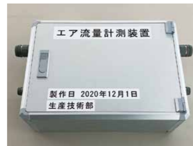
圧縮エアの漏れを検知
