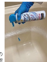
「らくハピ くるくるパブールン お風呂まるごと」の噴射試験で噴射状態や噴射量を確認
