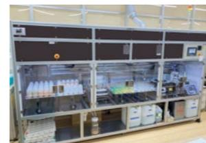
「温泡」の有効成分含量測定用検体自動処理装置
